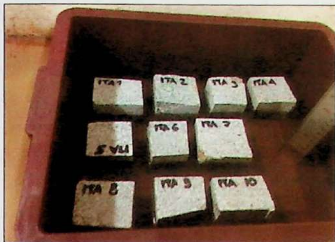
FIGURA 10: Corpos-de-prova durante o processo de submersão em água.
