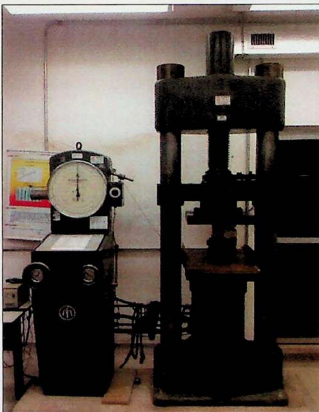
FIGURA 05: Prensa utilizada para rompimento dos corpos-de-prova e obtenção da força de ruptura, para cálculo da Resistência à Compressão Uniaxial.
