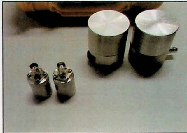
FIGURA 06: Pares de transdutores utilizados nas medições, de 54 kHz (menores) e 150 kHz (maiores).
