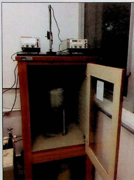
FIGURA 04: Equipamento utilizado para obtenção dos valores de variação para cálculo do coeficiente de dilatação térmica linear.
