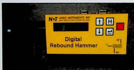
FIGURA 12: Esclerômetro Digital Rebound Hammer (do tipo L), modelo W-D 1500, fabricado pela NDT James Instruments Inc.
